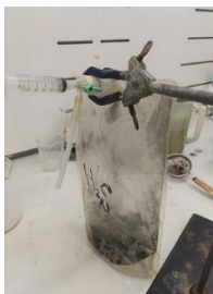
ドラフト内における硫化水素の発生
