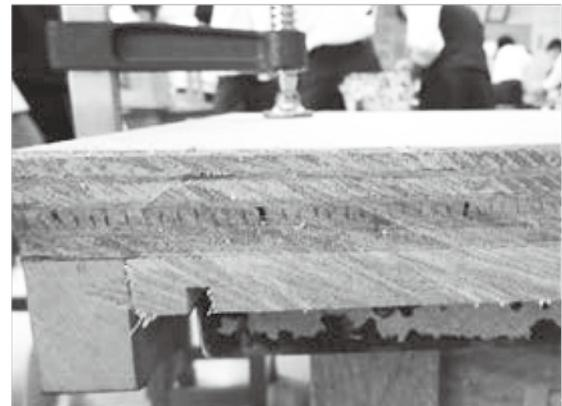
一つのグループが、肘の動きに留意し、のこぎりを水平にして切断作業を試みた。その結果、板材を真っすぐにかつ切断面をきれいに切断できていた。単元のまとめで、その時の切断方法のポイントについて発表したことで、クラス全体で共有することができた。
