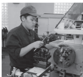
図3 四爪チャックの心出し
