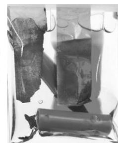
が取り出せることや、電極の極性を調べることができる。さらに回路を短絡させることで5分間の放電で Zn 電極がぼろぼろになる様子を観察できる (図3)。そして、袋止めクリップで透明度の高い PP 袋を止めているため手に持った状態で目の前で電極の変化を観察できる。また PP 袋を軽く押すことで電極に直接接触りその状態を確かめることもできる。
